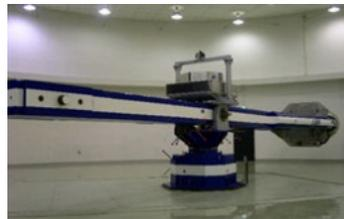
⑧旋回腕型加速度試験設備
