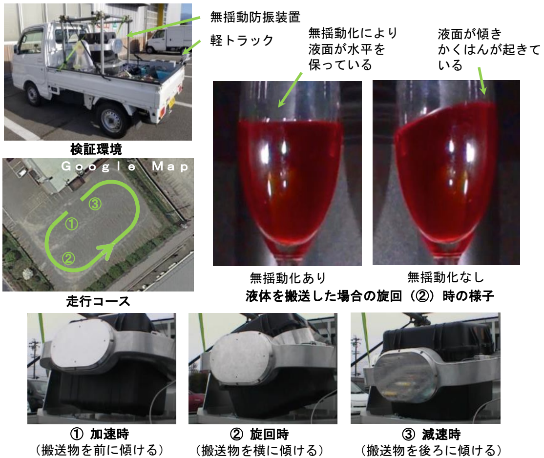
図3 無揺動化の動作検証の様子
